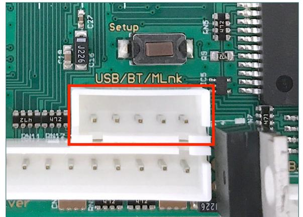
Mit dem optional erhältlichen *EIMod Bluetooth* ist auch eine kabellose Verbindung sowie die Konfiguration über ein Android Gerät.
