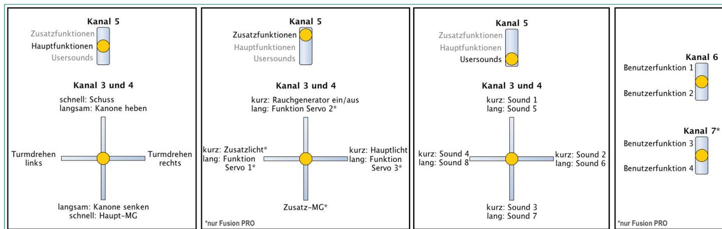
Die jeweilige Belegung ist unten abgebildet. Kurze Betätigung bedeutet Ausschlag für ca. 1 Sekunde, lange Betätigung bedeutet Ausschlag für 2 Sekunden oder länger.
