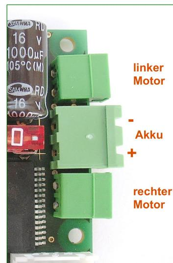
Unterschreitet die Akkuspannung eine bestimmte Schwelle, erfolgt eine Schutzabschaltung. Die entsprechenden Spannungswerte hängen vom eingesetzten Akkutyp ab und sind der obigen Tabelle zu entnehmen.
