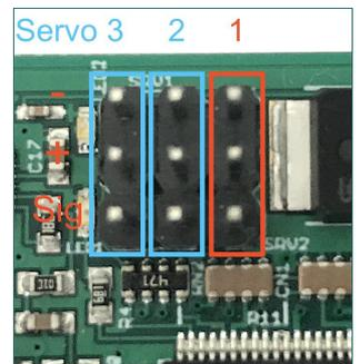
Die Luken- und Radarfunktion sind Sonderfunktionen, die über die Zusatzfunktionen der Funksteuerung betätigt werden (siehe Abschnitt "Funktionsteuerung"). Ist zum Beispiel die Kommandantenluke dem Servo 1, AA-Radar dem Servo 2 und die Fahrerluke dem Servo 3 zugewiesen, werden diese Funktionen wie folgt ausgelöst:
