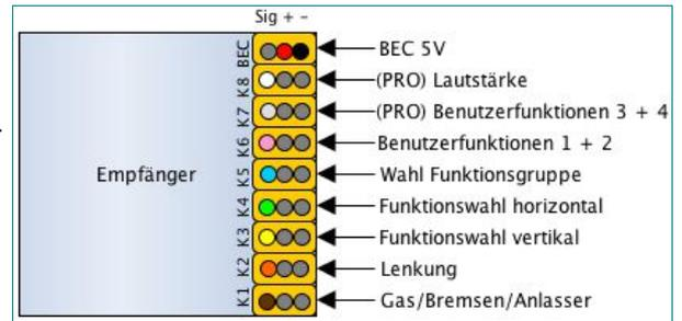
Je nach Anlage kann es nötig sein, die Kanalreihenfolge anzupassen oder den Servoweg umzudrehen. Lesen Sie dazu die Anleitung Ihrer Funkfernsteuerung. Das Signal von Kanälen, die in der Senderanlage unbelegt sind, unterscheidet sich von Hersteller zu Hersteller. Es ist aus diesem Grund wichtig, dass Leitungen von unbenutzten Kanälen NICHT angeschlossen werden.
